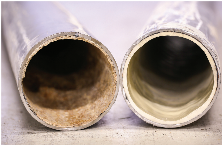
Tubazione modello prima e dopo l'applicazione della tecnica E-Flake.
